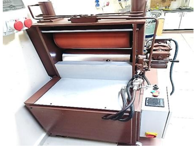
Şekil 2. Laboratuvar tipi iki silindirli yumuşak kalenderleme cihazında
