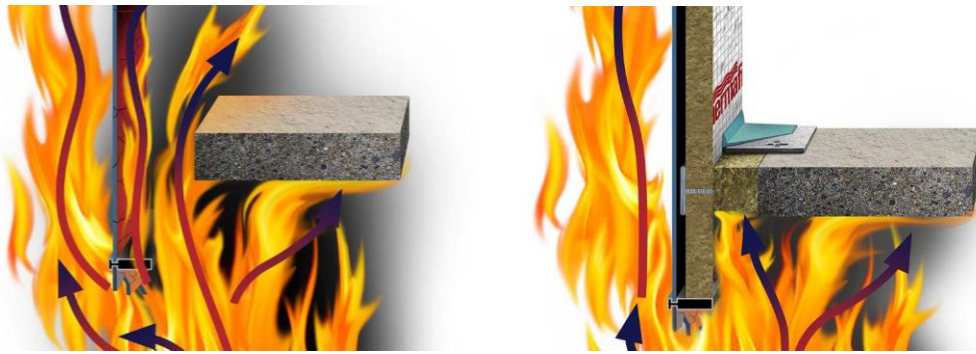
Şekil 6. Cephe ve döşeme birleşimlerinde sızdırmazlığın sağlanması (Ogino, 2019)
