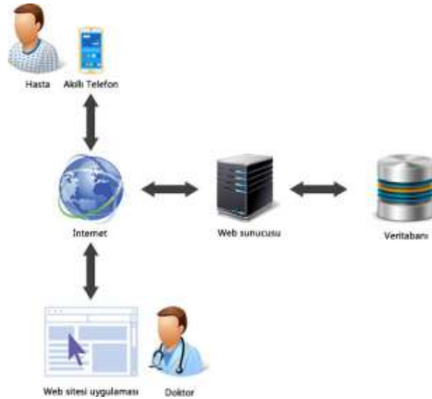
Şekil 1. Mobil hasta takip sistemi ve değerlendirme sistemi mimarisi
