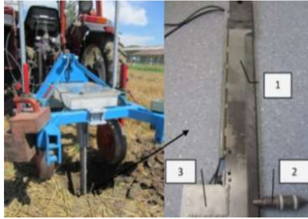
Şekil 15. Traktöre monte edilmiş kombine yatay penetrometre (1: Ayak, 2: Kombine sensör ve 3: Yük hücresi muhafazası) (Naderi-Boldaji ve ark., 2012).
