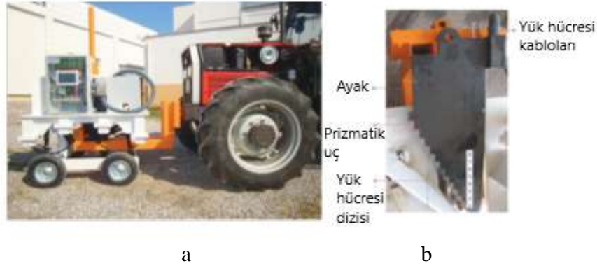
Şekil 17. (a) Traktör bağlantı sistemine sahip sensör,(b) Sensör bıçağı: sensör ayağı, algılama ucu, yük hücreleri ve kablolar.
