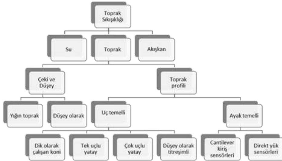
Şekil 7. Toprak sıkışıklığı ölçümü için geliştirilen sensör sistemlerinin sınıflandırılması (Nagendra ve ark., 2018).
