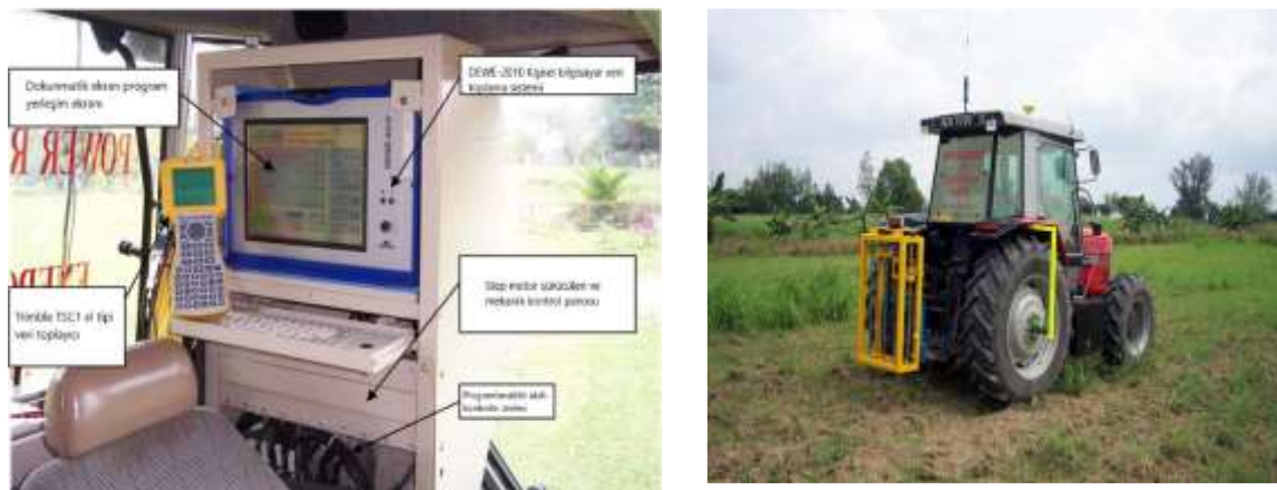
Şekil 6. Veri toplama sistemi ve traktöre monte edilmiş toprak penetrometresi (Boon ve ark., 2005).
