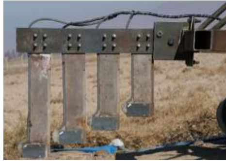
Şekil 14. Çoklu bıçaklı toprak mekanik direnç ölçüm sistemi (Abbaspour-Gilandeh ve ark., 2010).
