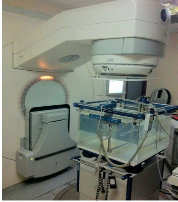
Şekil 1. Lineer hızlandırıcı, su fantomu ve dedektörlerden oluşan ölçüm düzeneği.
