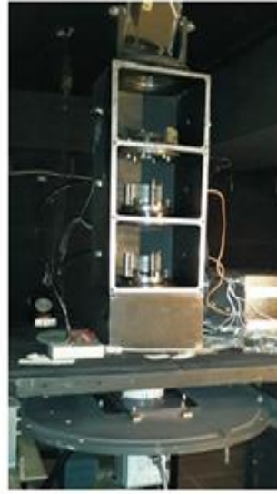
Şekil 3. DEFPOS tayföçerinin coude odasındaki konumu ve basit şematik gösterimi [13]
