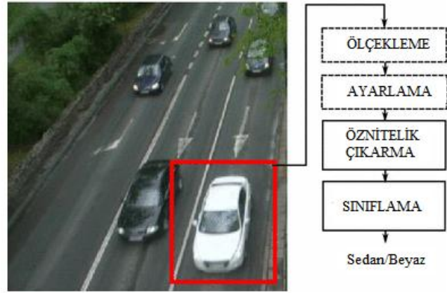
Şekil 1. Video Dedektör ile Araç Algılama ve Sınıflama Adımları
