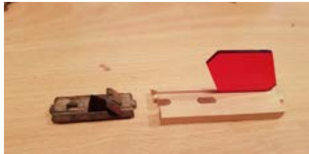
Görsel 11 Eski ve yeni şebeke yapımında kullanılan cam ve çerçeve. Sağ: yeni; Sol: Han Sarayı (eski) Onarım için gelen cam ve çerçeve (S. Ünal, 2019).
