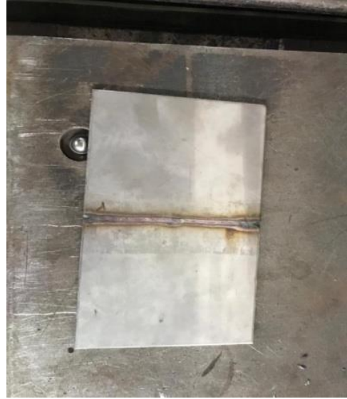
Şekil 2. TIG kaynağı ile birleştirilmiş AISI 304 paslanmaz çelik sac numune (AISI 304 stainless steel sheet sample combined with TIG welding)
