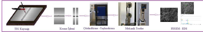
Şekil A. Deney sürecinin şematik gösterimi / Figure A. Schematic illustration of experimental process
