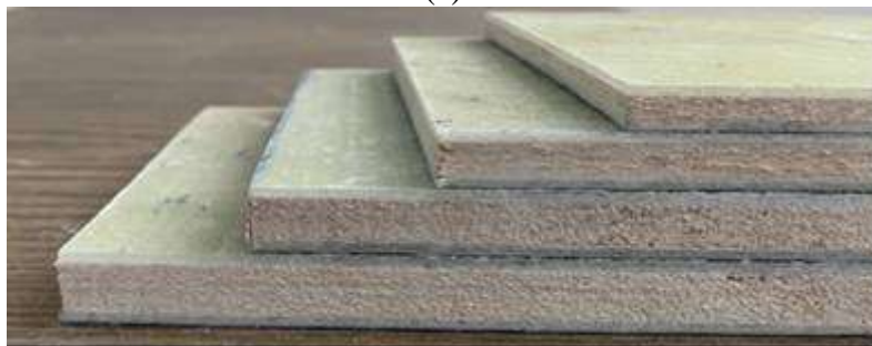
Şekil 2. (a) Darbe test numuneleri (b) Farklı kalınlıktaki balsa çekirdekli sandviçler
