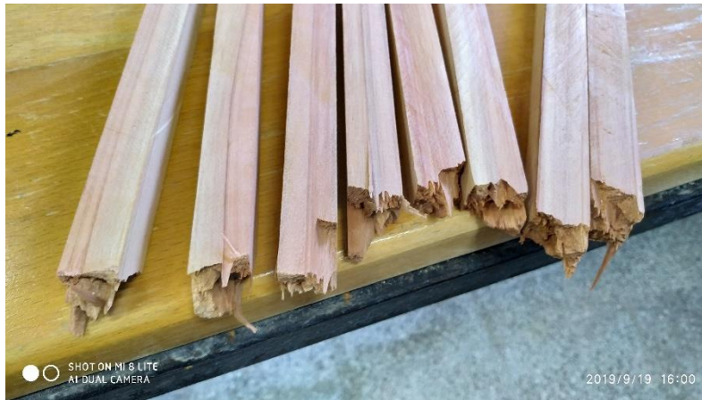
Resim 4. Şok direnci kırılma örnekleri.
