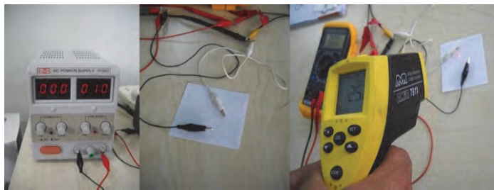
Şekil 5. Voltaj regülatörü, gerilim uygulanan nitinol tel ve lazerli termometre ile sıcaklık ölçümü
