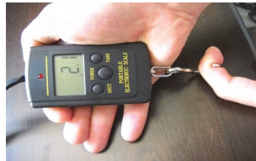
Şekil 7. Dijital el dinamometresi aracılığıyla parmak hareketi için gerekli gücün ölçümü
