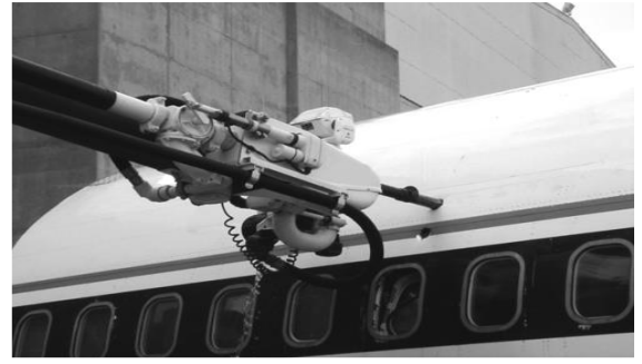
Şekil 2 Uzatmalı Çatı Monitörü ile havalandırma deliği açma [10]
