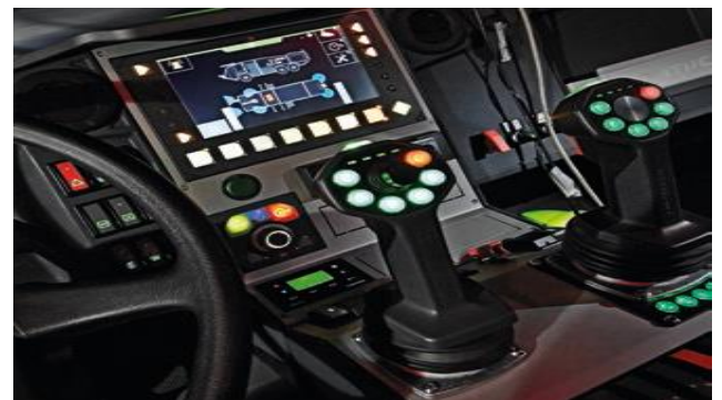
Şekil 6 Uzatmalı Çatı Monitörü kontrol kolu [10]
