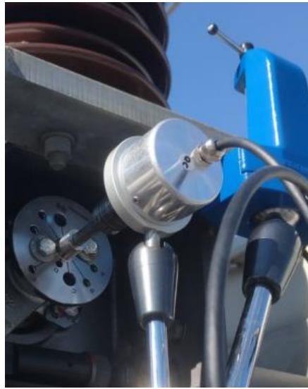
Resim 3. Dijital açısal transdüzer bağlantısı Photo 3. Digital angular transducer connection
