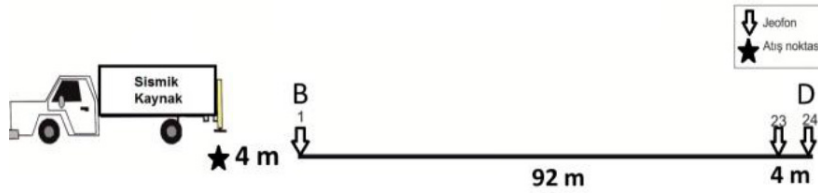
Şekil 8. Arazide uygulanan MASW ölçüm düzeneği.
