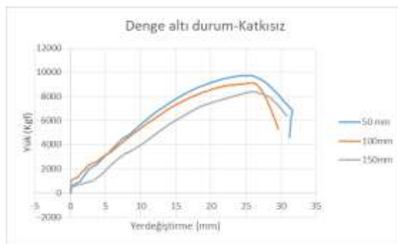
Şekil 9. Katkısız ve %20 Katkılı Numunelerde Etriye Adım Mesafesine Göre Yük-Yer değiştirme Eğrileri Figure 9. Load-Displ. Curves According to Stirrup Step Distance for Non-Additive and 20% Additive Samples
