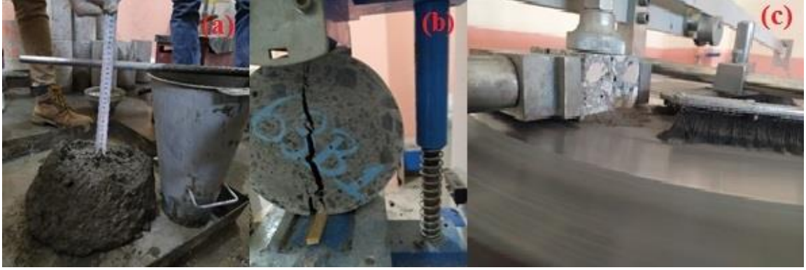
Şekil 3. Çökme deneyi (a), yarmada çekme deneyi (b) ve aşınma deneyi (c).
