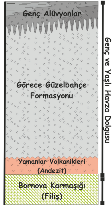
Şekil 5. Çalışma alanına ait olası zemin-mühendislik ana kayası şematik stratigrafik kesit (Uzel vd. 2012; Sözbilir vd. 2008).
