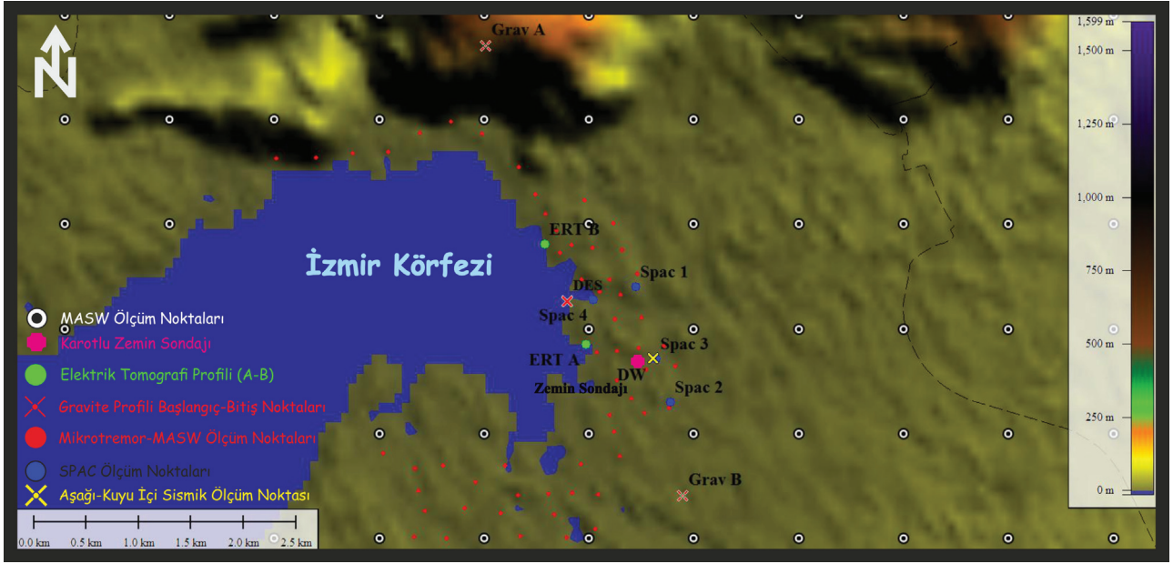
Şekil 6. Karotlu Zemin Sondajı, Mikrogravite (Grav), Mikrotremor, MASW, SPAC, Down Hole (Aşağı-Kuyu içi Sismik) ve Elektrik Tomografi (ERT) uygulama lokasyonları.
