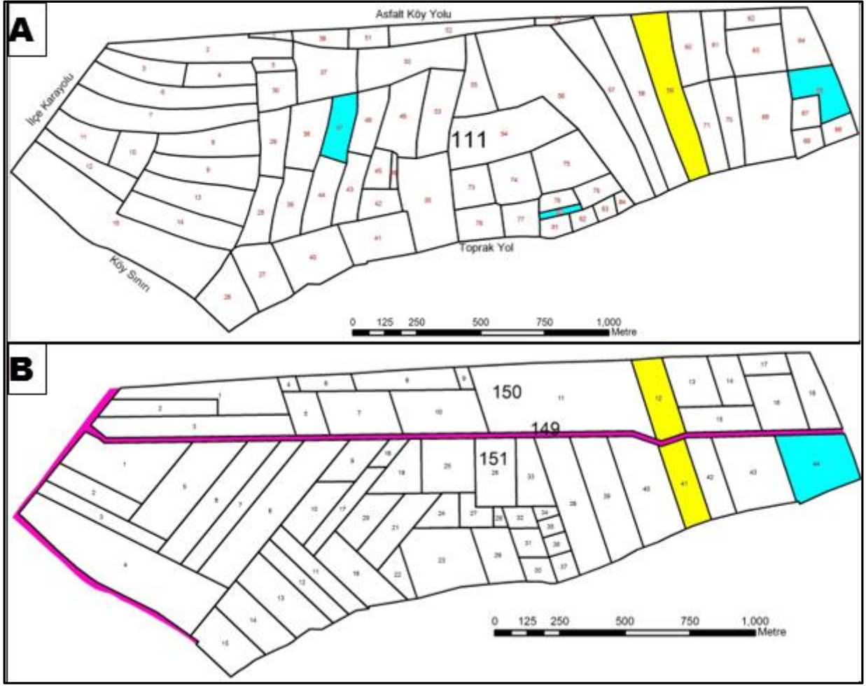
Şekil 4. Kayseri-Develi-Tombak Mahallesi KD'sinden Önceki (A) ve Sonraki (B) Durumu Uygulamaya giren bütün parseller için dağıtım listesinin makalede verilmesi makalede sunulması teknik olarak mümkün olmadığı için, düzenlemeye giren parsellerden özelliklerine göre örnek parseller seçilerek listelenmiştir. Bu parsellerden örnek verecek olursak;
