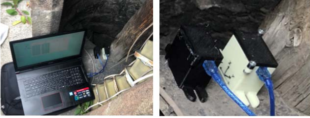
Şekil 6. Minarenin restorasyon öncesine ait ÇTT ve ivmeölçer yerleşim düzeni (AVT of the minaret before restoration and accelerometer layout)
