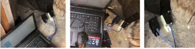
Şekil 14. Minarenin restorasyon sonrasında ait ÇTT ve ivmeölçer yerleşim düzeni (AVT of the minaret after restoration and accelerometer layout)
