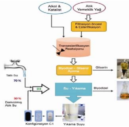
Şekil 6. Biyodizel üretim sürecinin genel şeması ve biyodizel yıkama suyunun yeniden kullanımı (Jaber ve ark., 2015)
