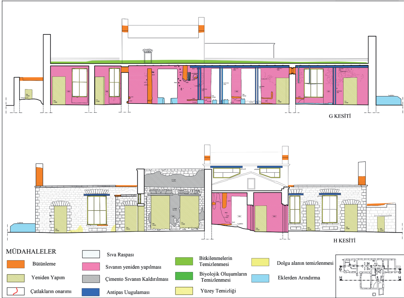
Şekil 13: Yapıdaki bozulmalar için önerilen müdahaleler / Drawings of interventions
