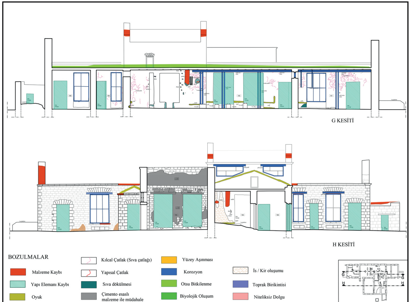
Şekil 12: Yapıdaki bozulmaları gösteren çizimler / Drawings of deteriorations
