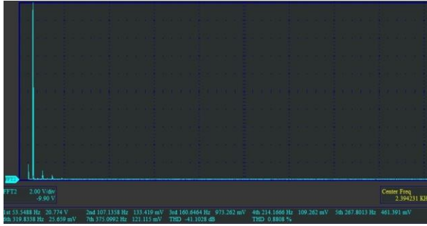
Şekil 22. Balast Yük devre dışı iken THD %0,88 (During Ballast Load disabled THD %0,88)
