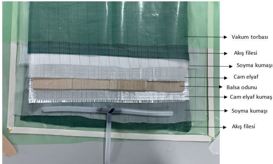
Şekil 2. Üretimde kullanılan sarf malzeme, balsa odunu ve cam fiber kumaşların dizilimi.
