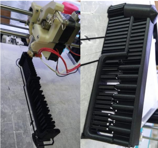
Şekil 5. İmdat çekici plastik aksamı tasarımının 3B yazıcıda üretim süreci aşamaları
