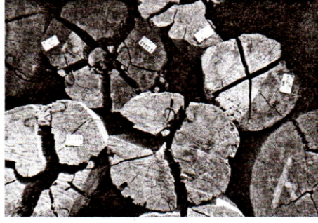
Şekil 1. Uzun süre depoda bekletilmiş meranti tomruklarında meydana gelen derin çatlak ve yarıklar (Kantay, 1995).
