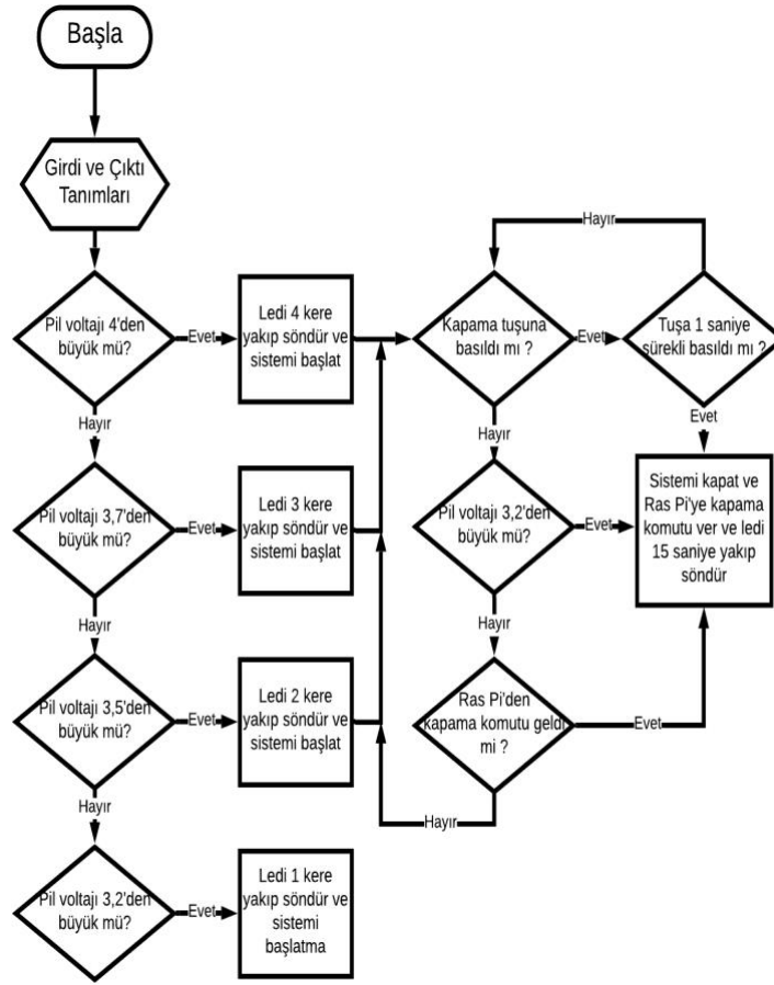
Şekil 10: Attiny 85 için yazılan programın akış diyagramı.
