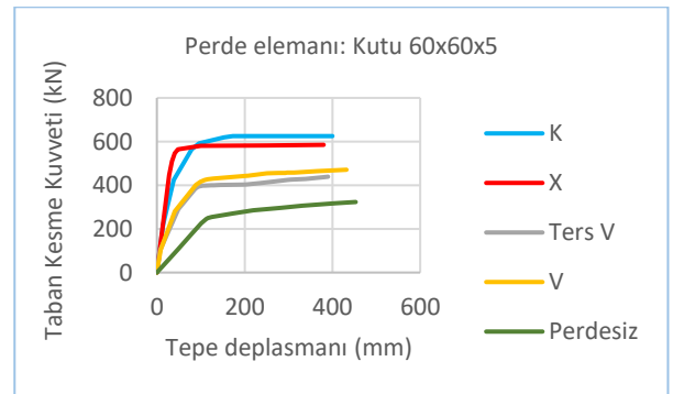
Şekil 9. Perde elemanı 60x60x5 için yapı performans eğrileri
