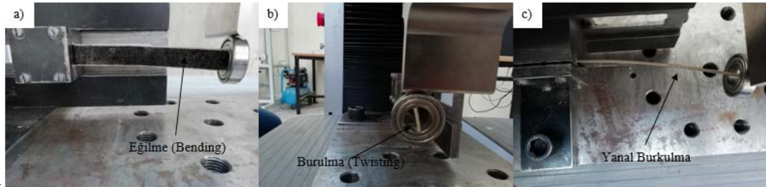
Şekil 7. Yanal burkulma deneyinde numune davranışı; (a) Ön görünüm, (b) Yan görünüm, (c) Üst görünüm (The sample behavior in lateral buckling experiment; (a) Front view, (b) Side view, (c) Top view)
