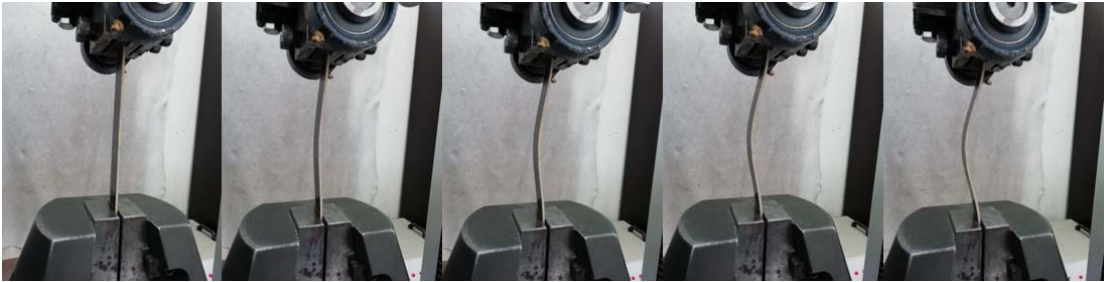
Şekil 4. Eksenel burkulma deneyinde numune davranışı (The sample behavior in axial buckling experiment)
