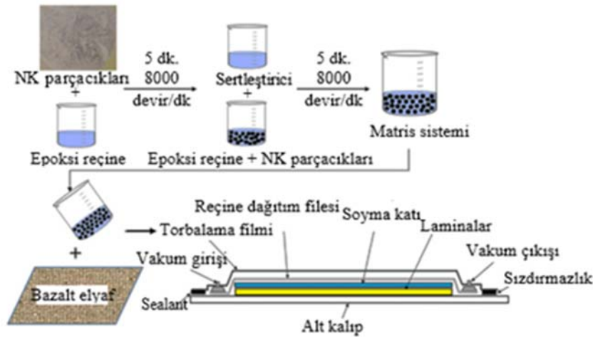
Şekil 1. Test numunelerinin üretim süreci (Preparation of test samples)
