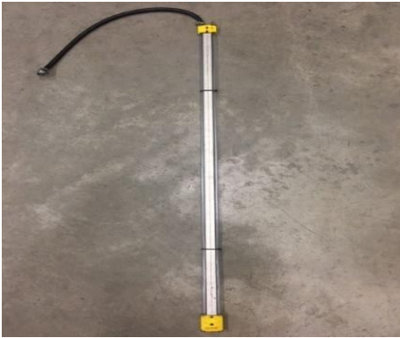
Şekil 4. Sulu tip U-manometre
