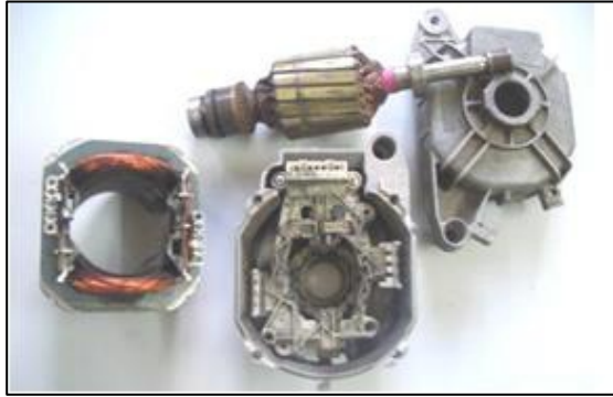
Şekil 2. Üniversal motorun yapısı.
