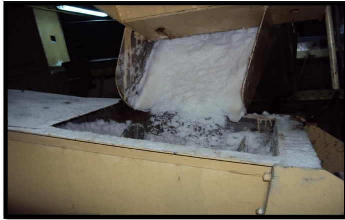
Fotoğraf 2.8. Şerbetten Ayrılan Nemli Haldeki Şeker.
