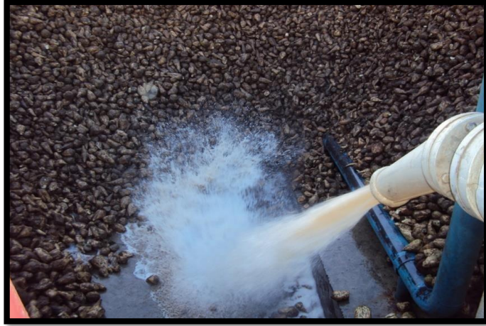
Fotoğraf 2.5. Pancarın Basınçlı Su İle fabrikaya Alınması.
