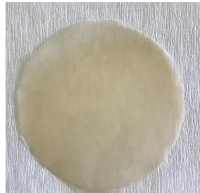
Figure 4 NaAlg / HPMC / CA-30/ TiO 2 nanocomposite membrane
