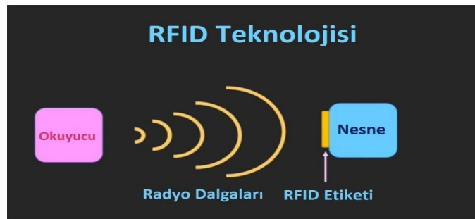
Şekil 3. RFID teknolojisinin çalışma prensibi (URL-5)
