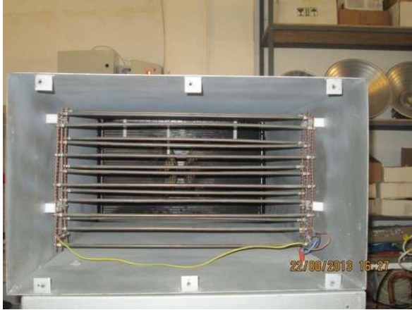
Şekil 2. Hava kanallarındaki rezistansların genel görünümü (Overview of resistance in the airducts)
