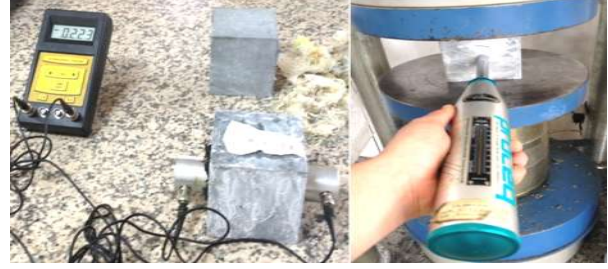
Şekil 9. Ultra ses geçiş hızı ve Schmidt test çekici deneyi (Ultra sound transmission rate Schmidt hammer test)
