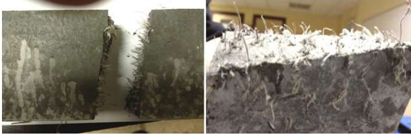
Şekil 15. UPP lifin SİFCON'un içindeki görünümü (UPP in view of the fiber SIFCON)
