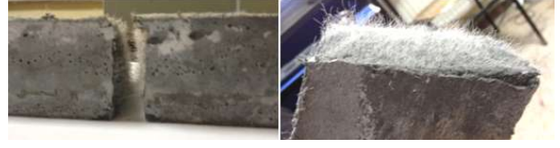
Şekil 17. KPP lifin SİFCON'un içindeki görünümü (KPP in view of the fiber SIFCON)
