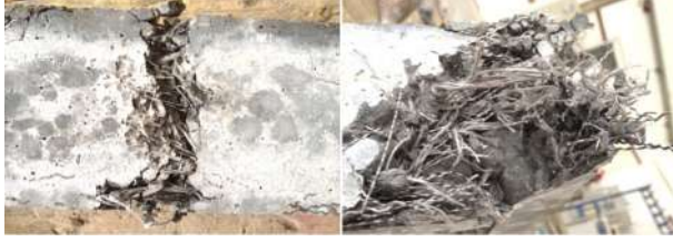
Şekil 25. DÇ ve UPP lifin SİFCON'nun içindeki görünümü (DC and UPP fiber is view of in the SIFCON'S)
