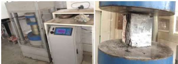
Şekil 8. Basınç dayanımı testi (Compressive strength test)
