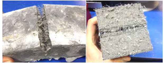
Şekil 19. UPP ve KPP karma lifin SİFCON'un içindeki görünümü (UPP and KPP in the view of the fiber composite SIFCON)
