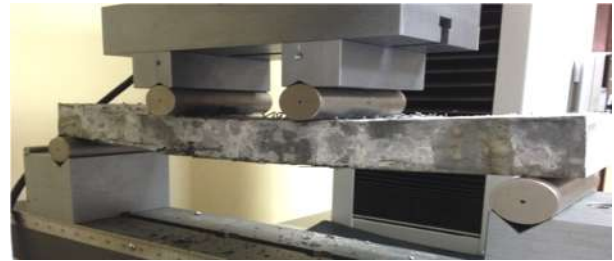
Şekil 10. Dört noktali yükleme deneyi (Four-point loading test)
