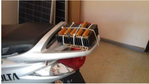
Şekil 10. Dinamik frenleme direnci (Dynamic braking resistor)
