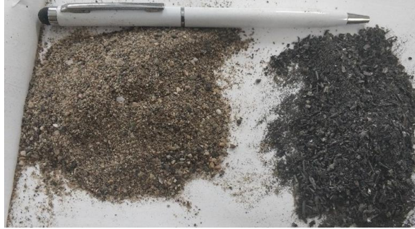
Şekil 2. Numune üretiminde kullanılan agrega ve atık demir tozu
