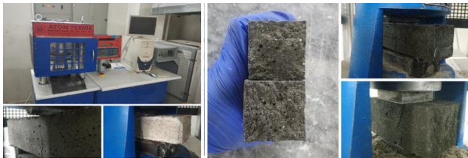
Şekil 4. Eğilme ve basınç deneyi cihazı ve deney görüntüleri
