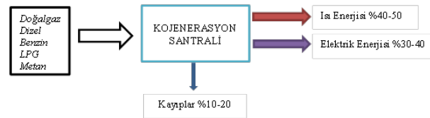
Şekil 1. Kojenerasyon sisteminin şematik görünüşü
