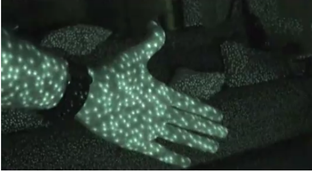
Şekil 2. Kinect sensörün lazer projektörü tarafından yayılan ışın noktalarının görüntüsü
