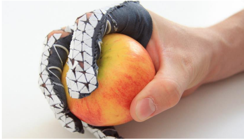
Şekil 8. 4D Baskılı dış iskelet yapısı (4D Printed exoskeleton structure) (Peters and Drewes, 2019)
