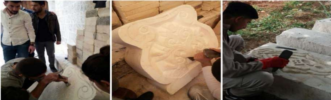
Şekil 12. Urfa taşının el işçiliği ile kolay bir şekilde işlenerek ürüne dönüşümü
