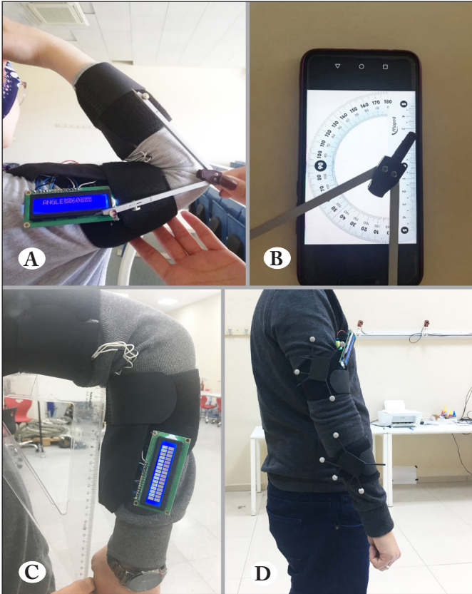
Şekil 3: Ölçümün alınması ve validasyonu, A-B) Sağ dirsek 60° fleksiyon hareketi pergel ile doğrulanması, C) Sol dirsek 90° ektansiyon hareketi gönye ile doğrulanması, D) OptiTrack işaretleyicilerin yerleşimi ve hareket yakalama laboratuvarı.
