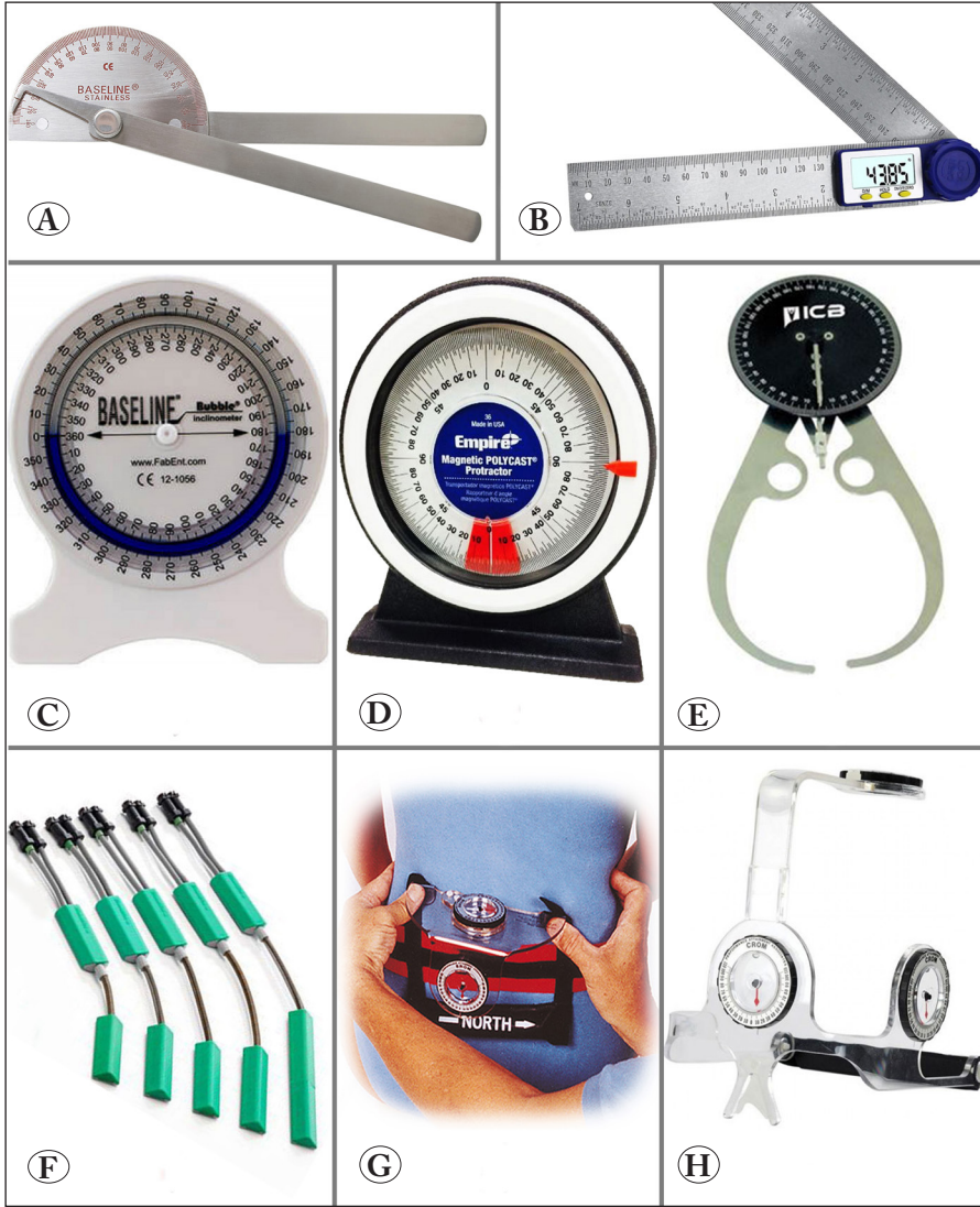
Şekil 1: Evrensel gonyometre çeşitleri, (A) Analog gonyometre, (B) Dijital gonyometre, Ölçümler için kullanılan gonyometre çeşitleri (C) Sıvı eğimölçer, (D) Pendulum eğimölçer, (E) Yerçekimsel gonyometre, (F) Elektrogonyometre, (G) BROM, (H) CROM.
