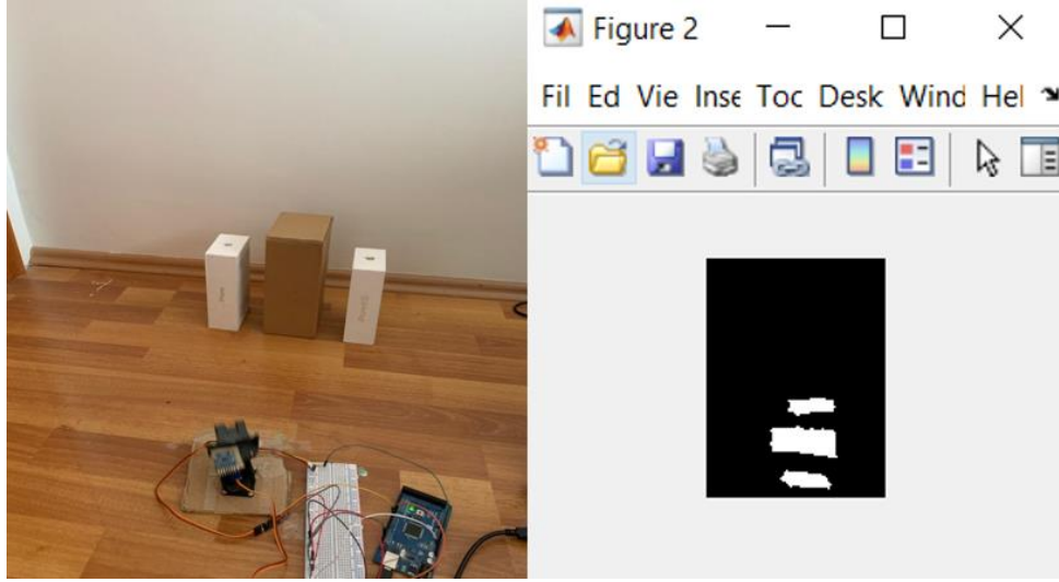
Şekil 8. Farklı boyuttaki modellerin ölçüm düzeneği ve Matlab çıktısı
