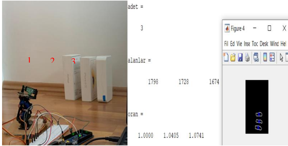
Şekil 9. Benzer boyuttaki modellerin ölçüm düzeneği ve Matlab çıktısı
