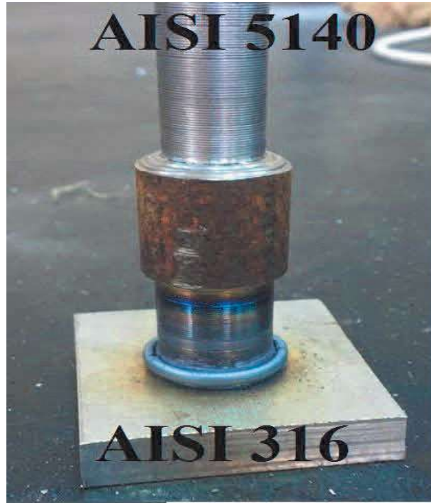
Şekil 1. Sürtünme karıştırma saplama kaynak eklemine makro görüntüsü
