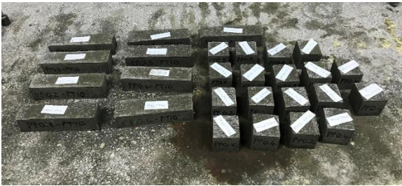
Şekil 1. 24 saat sonunda kalıptan alınan numuneler
