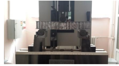
Şekil 2. Üretilen numuneler ve numunelerin test cihazına bağlanması
