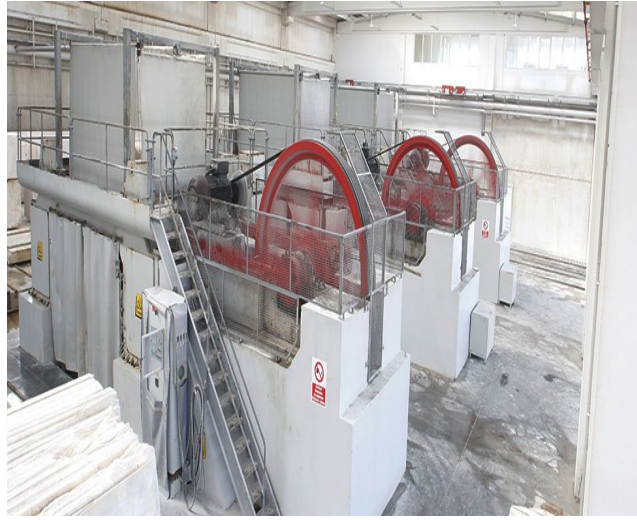
Şekil 1. Pedrini GS131-mermer kesiminde kullanılan kapalı çerçeveli katrik
