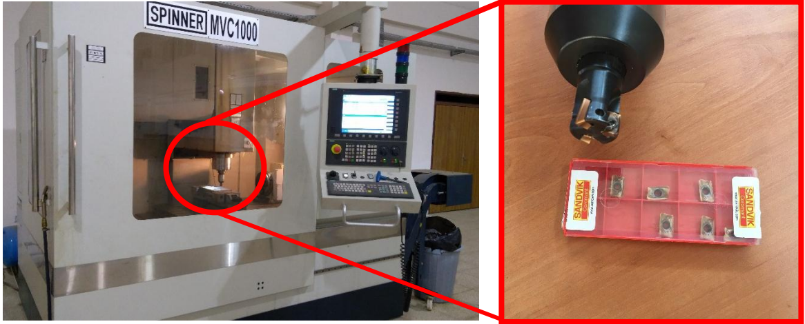
Şekil 2. (a) CNC Tezgahı, (b) Kesici takım ve üç ağızlı Tutucu
