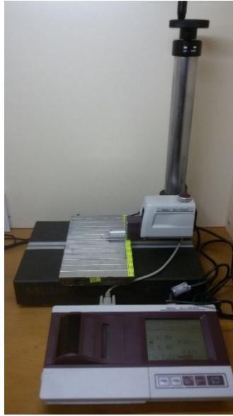
Şekil 3. Yüzey pürüzlülük cihazı ve pürüzlülük ölçümü
