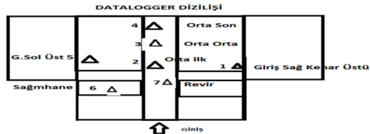
Şekil 2. İşletme Veri Kaydedici Ölçüm Noktaları (PCE-HT 71N Datalogger)
